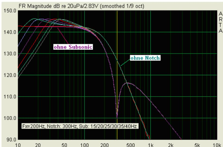
Das Subsonicfilter ist mit der Tiefbasskorrektur gekoppelt:
